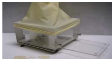
写真-1 水中付着膜採取器具(九大水理研方式)
