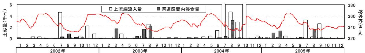
図-11 微細粒土砂の流入量、侵食量および貯水位
