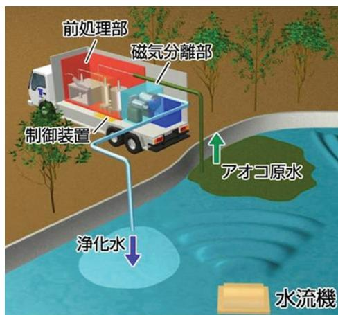
図-2 モービル型磁気分離システム
