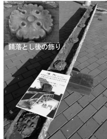
錆落とし前後の下弦材 (Eye Bar)
