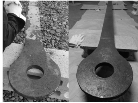
錆落とし前後の下弦材 (Eye Bar)
