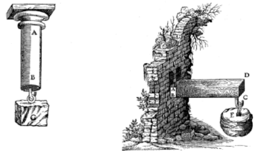
図-5 ガリレイの引張り、曲げを受ける梁の実験図 4)
