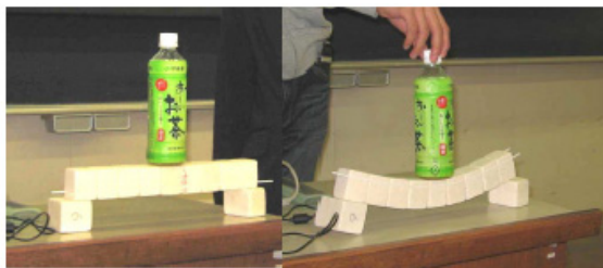
写真-5 正しい配筋 (左) と誤った配筋 (右)
