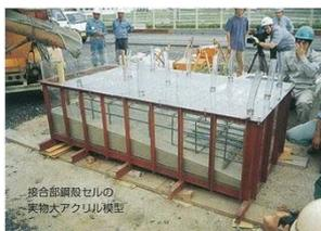
高流動コンクリート充填確認試験
