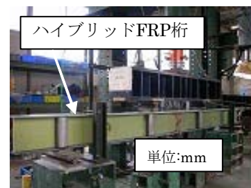
写真-1 載荷実験状況
