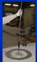
D16(11φ) 鉄筋が破断してもコンクリートの破壊はなし
