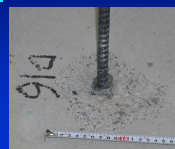
D16(8φ) 浅いコン クリート剥離のみで 鉄筋が降伏しても抜 けない。
