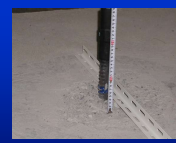
D25(8φ) 浅いコンクリート剥離のみで鉄筋が降伏しても抜けない。
