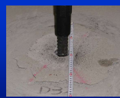
D32(8φ) 浅いコンクリート剥離のみで鉄筋が降伏しても抜けない。
