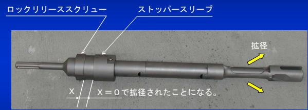
拡径専用ドリル(アンダーカッター)
