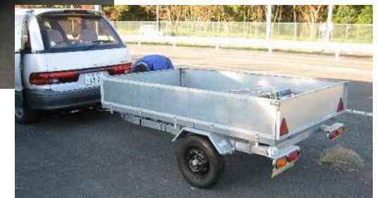
6分力計、前後輪のばね上・下に加速度計を設置した計測車両 (一般車両)
