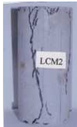
ポリマーモルタル
