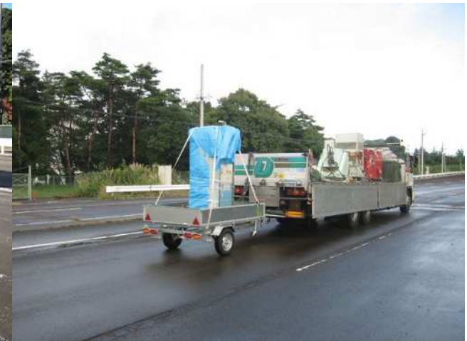
起振車両 (10tf車両に起振機などを配置し、牽引カーゴに制御ユニットを配置)
