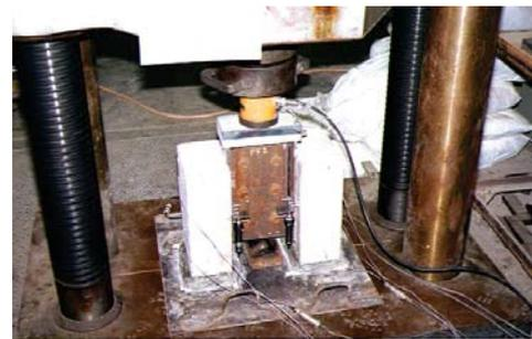
押抜き試験体の載荷状況
