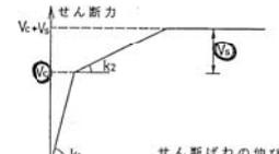
図6 RC部のせん断抵抗のモデル化
