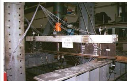
正曲げ桁試験体の載荷状況
