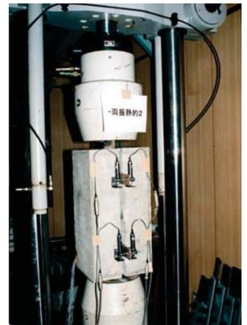
スタッドの両振り試験体の疲労試験状況
