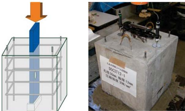
パラメータ: コンクリートの強度, 孔径, コンクリートブロックの寸法, 鋼板厚など
