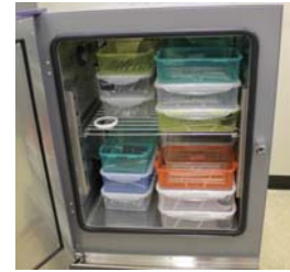
恒温恒湿器 温度 40°C, 湿度 60%, 5 か月間腐食促進
