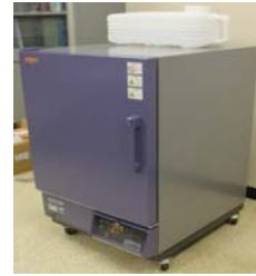
恒温恒湿器 温度 40°C, 湿度 60%, 5 か月間腐食促進
