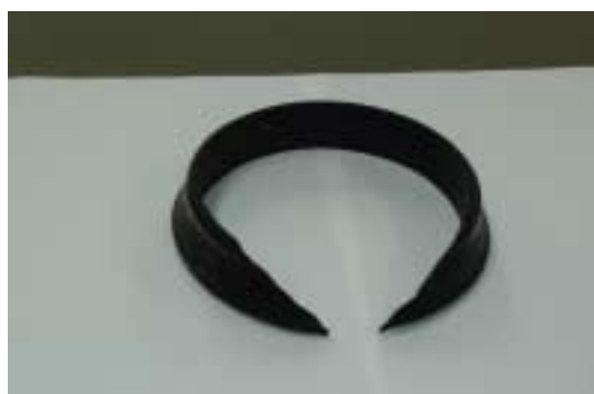
メカニカル継手の破損写真
