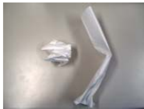
荷重に耐えられずに崩壊した柱状体 (左：高さが低い、右：高さが高い)
