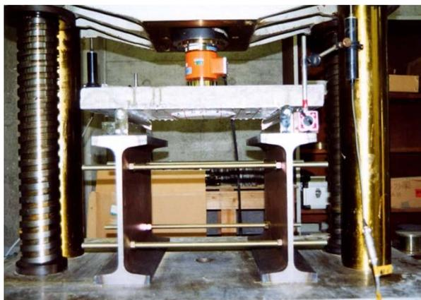
図-1 押抜き試験の実施例
