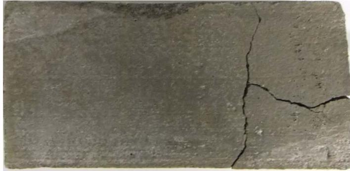
図 4.5.2 両引き試験後の供試体ひび割れ状況
