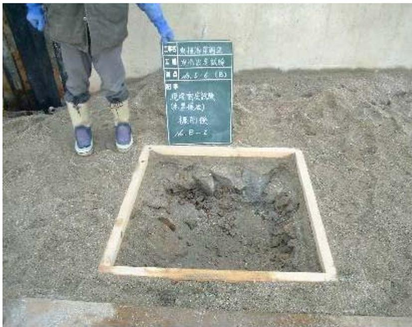
写真 - 7 雑石試験孔(B-2)
