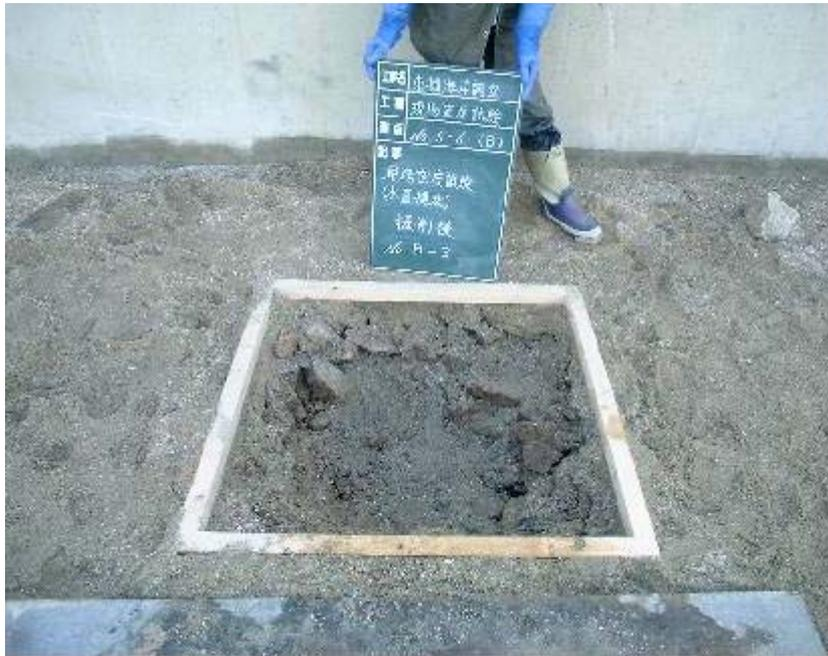
写真 - 8 雑石試験孔(B-3)
