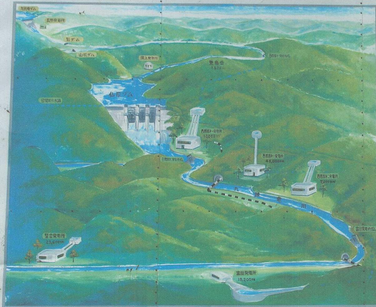
西勝原才三発電所は九頭竜川上流開発の一環として北陸電力の手で開発したものであります。当仏原ダムは九頭竜本流に高さ48.6メートル、堤頂長141メートルのコンクリート重力ダムを築いて調整池を設け、165万立方メートルの有効貯水量を湛水します。発電所では、この調整池から毎秒56立方メートルの発電用水を取水し延長約3キロメートルの圧力トンネルで導水し有効落差99.0メートルを利用して最大4万8千キロワット年間2億6千万キロワットアワーの電力を発電します。
