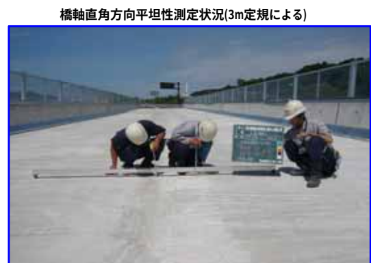
図-4.3 上面増厚施工後の平坦性測定結果(橋軸直角方向)
