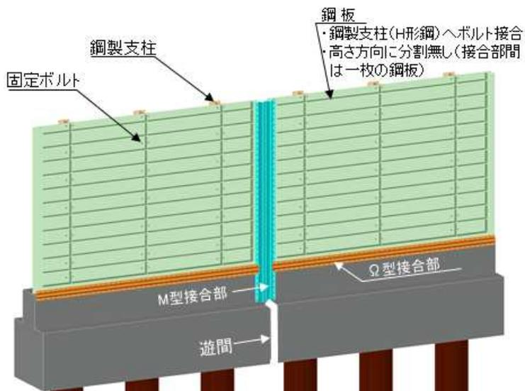
鋼製遮水壁（鋼板）の構造概念図
