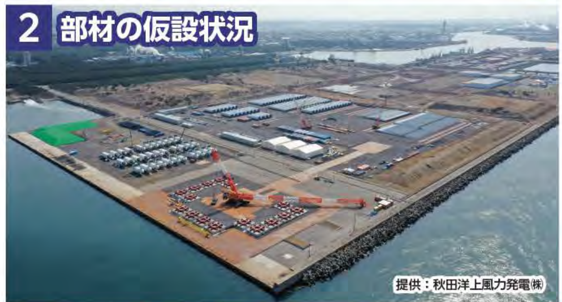
※洋上風車の部材を扱うために地盤強化工事を実施
