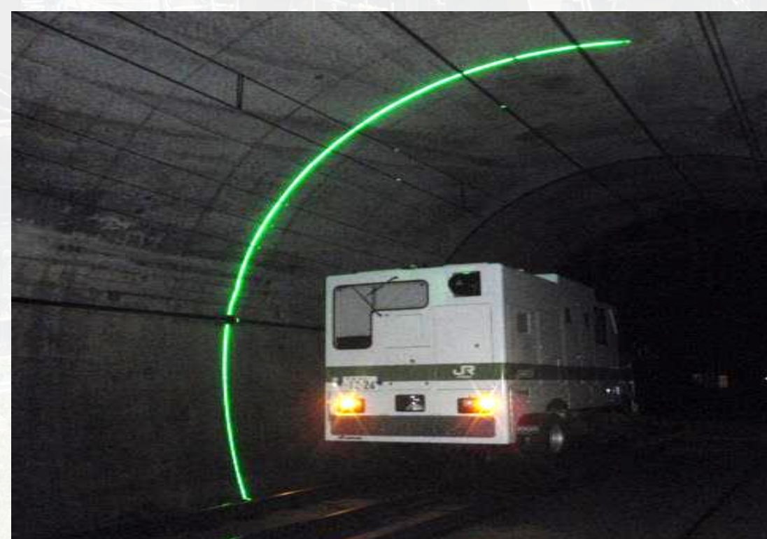
トンネル覆工表面撮影車
