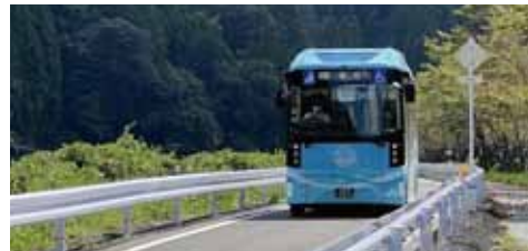
彦山駅一宝珠山駅間を専用道とするBRT(バス高速輸送システム)
