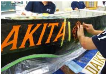
カッティングシート貼付け
