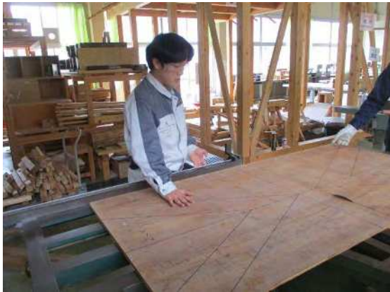
型枠切り出し
