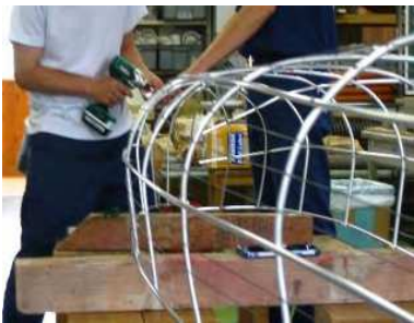
骨組みと弁バネ用鋼線結束
