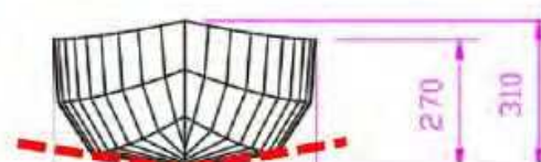
操作性と浸水を考慮した高さ
