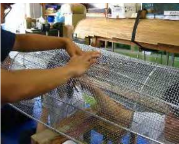
亜鉛金網張り付け
