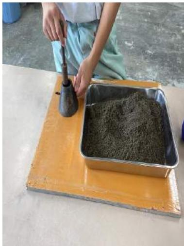
図1 細骨材密度試験
