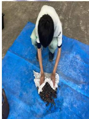
図2 粗骨材密度試験
