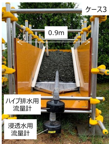
写真-1 完成した模型盛土の様子（ケース3）
