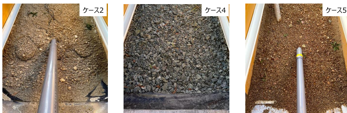
写真-2 表面侵食状況の比較 (撮影日 2019 年 12 月 3 日)
