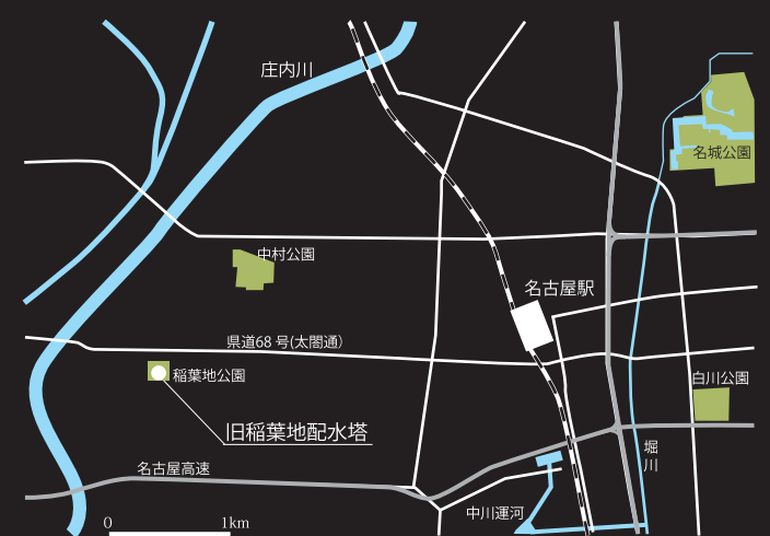
名古屋市水道の第四期拡張工事の実施路線「東山配水塔」から重力で送り出された水が、名古屋市街地を横切り稲葉地の配水塔上の水槽まで届くため稲葉地配水塔には揚水施設がない。（『名古屋市水道局五十年史』1925）
