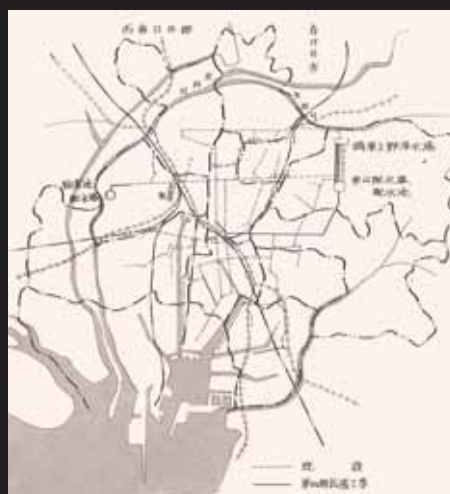
名古屋市水道の第四期拡張工事の実施路線「東山配水塔」から重力で送り出された水が、名古屋市街地を横切り稲葉地の配水塔上の水槽まで届くため稲葉地配水塔には揚水施設がない。（『名古屋市水道局五十年史』1925）
