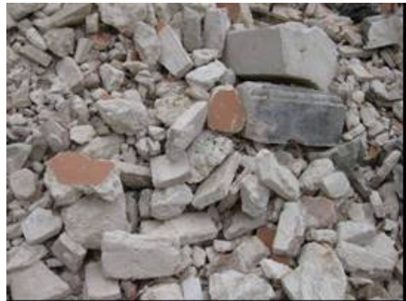
写真-32 崩壊した組積材と仕上の残骸
