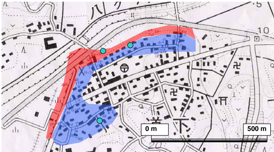
図 6 門前の道路に現れた亀裂：青が開口、赤が圧縮である。青から赤に向かう形で地盤が移動した痕跡である（郵便局、N37度17分23秒、E136度44分37秒）。図中青丸は水位確認した井戸
