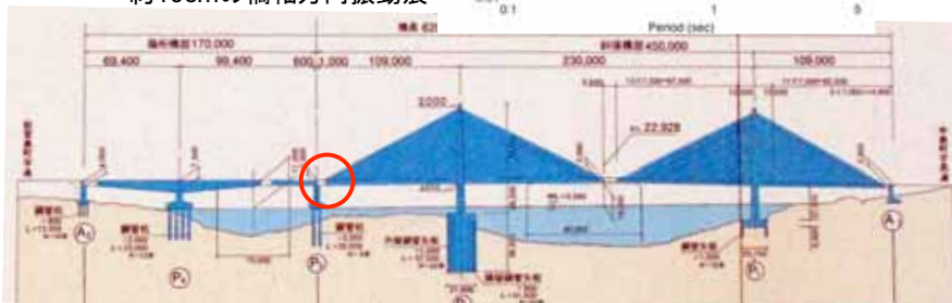
約10cmの橋軸方向振動痕
