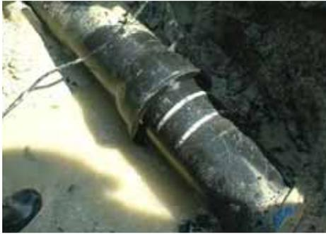
写真 9.1.4-1 200DIP の T 形継手の抜け
