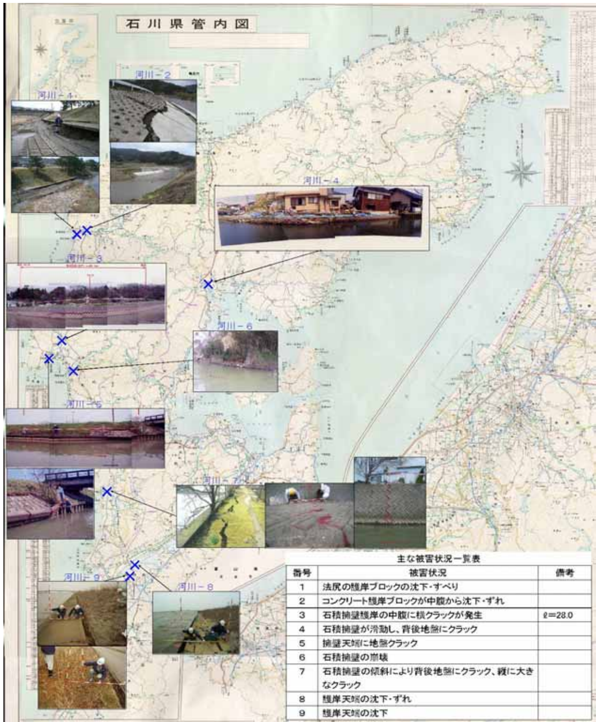
図 8-2 主な河川被害位置及び被害状況写真
