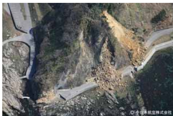
写真 4.1.4-2 隣接した 2 箇所の斜面崩壊(S-9 地点) (中日本航空株式会社撮影)
