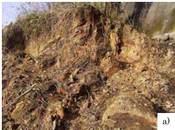
写真 9 220km500m 付近の盛土材料(盛土材料は円礫が混じっているが、多くは細粒分質砂であった。密度は非常に高いように見えた)
