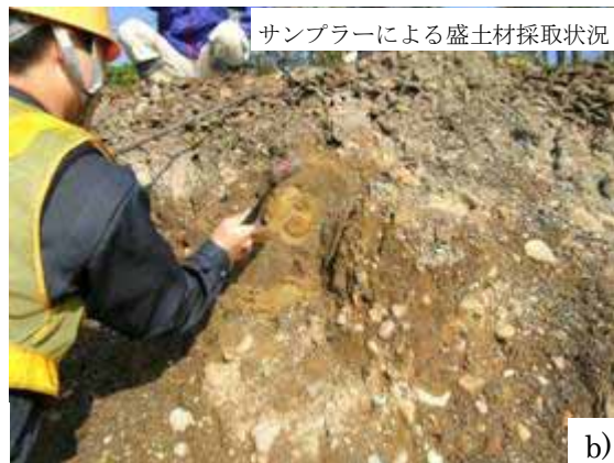
写真 9 220km500m 付近の盛土材料(盛土材料は円礫が混じっているが、多くは細粒分質砂であった。密度は非常に高いように見えた)
