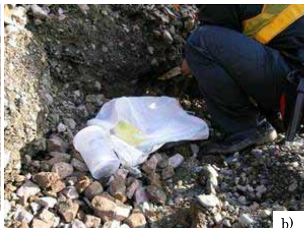
写真5 盛土材料(220km900m 付近：円礫が混じっているが、多くは細粒分質砂であり、締め固め度は高くないように感じられた)
