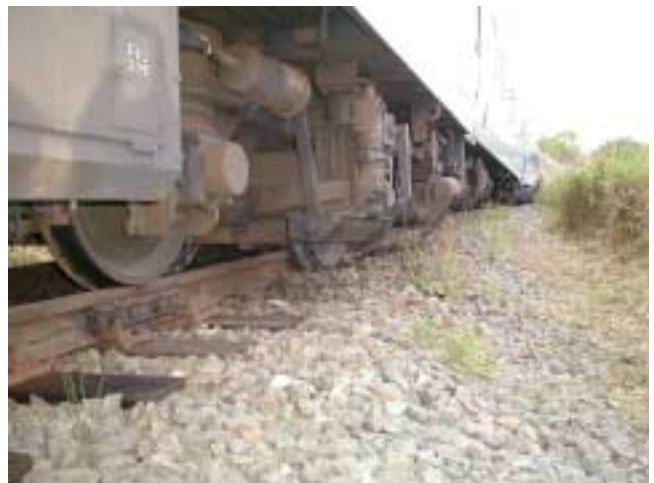
写真 - 3 列車の脱線状況
