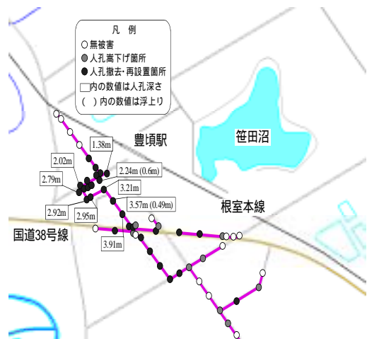
図1 下水マンホールの被災箇所(豊頃町豊頃駅前，豊頃町から資料提供を受けてまとめたもの)
