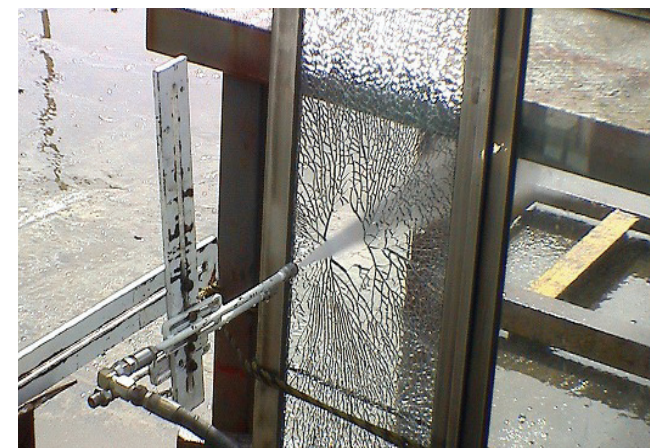
図-7 強化ガラス(8mm)の破壊試験
