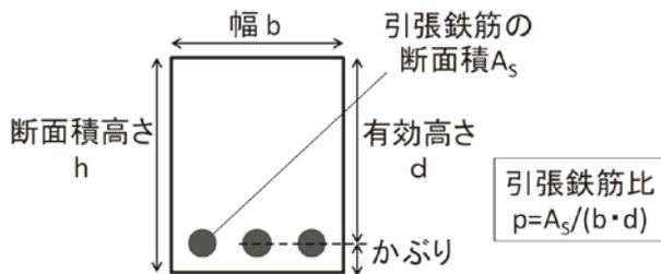
図1 引張鉄筋
