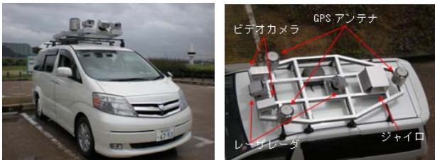
図-8 三菱MMSの外観・上部計測ユニット
