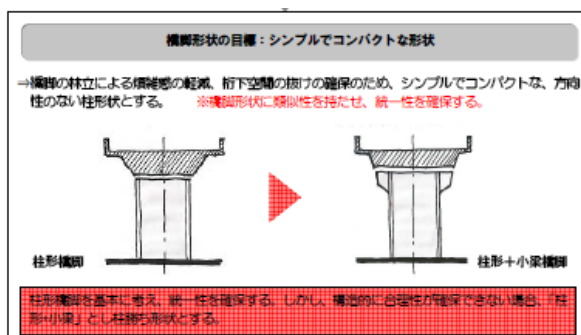
図-14 橋脚形状のデザインの考え方
