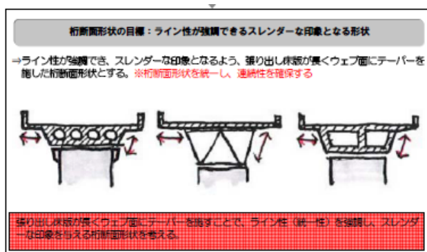
図-13 桁断面形状のデザインの考え方
