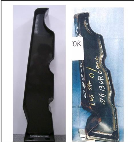
図-2 局部座屈タイプの防護柵の変形例
