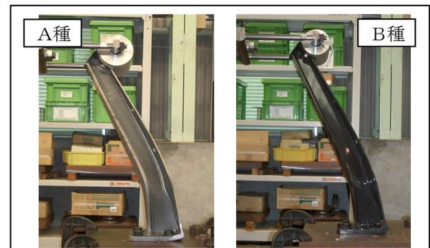
図-9 供試体(A種左側、B種左側)の静荷重試験の状況
