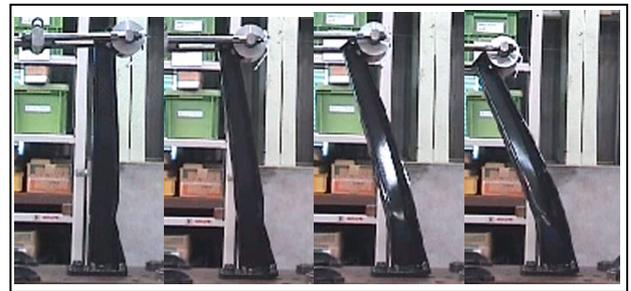
図-18 荷重試験における支柱の変形状態
