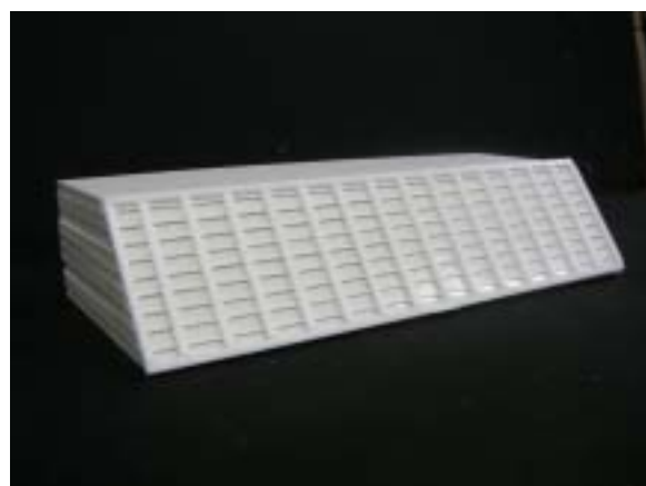
図-2 実験模型（四角型プロポーション0.2縦太横細）
