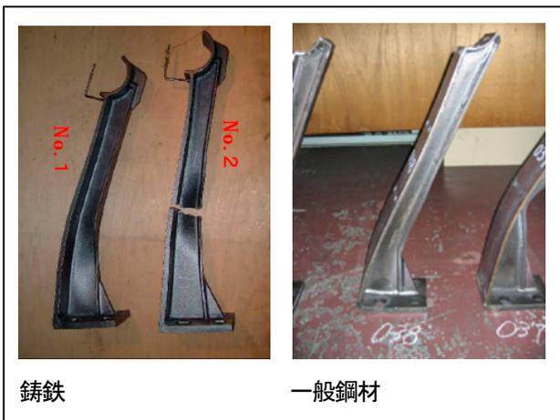
図-4 静荷重試験の状況写真
