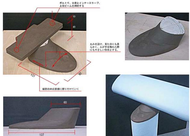
図-6 模型によるブラケットの形状検討
