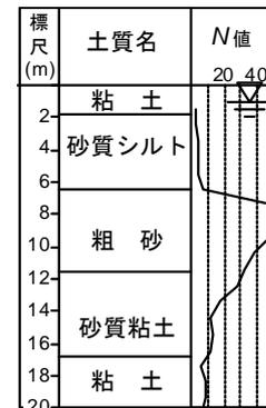
図4.2.4 刈谷田川旧河道の土質柱状図<sup>2)</sup>
