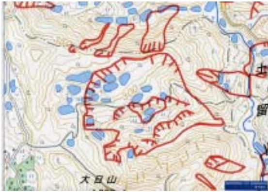
図-3.2.18 小千谷市塩谷地区での斜面崩壊と近傍の地形
