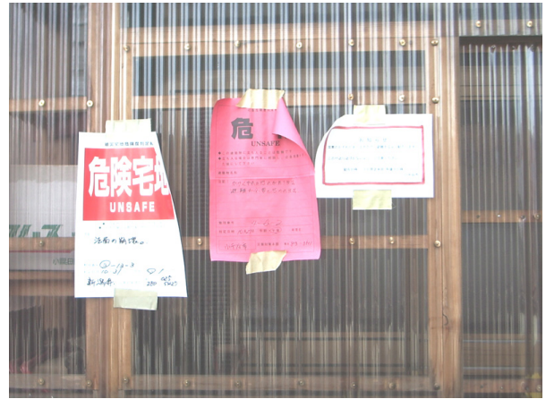
写真 10.3.1 判定結果ステッカー表示 (小千谷市) (左側：被災宅地危険度判定、中央：被災建物危険度判定、右側：小千谷市のお知らせ)
