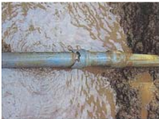
写真-2 75 VPのRR継手の破損
