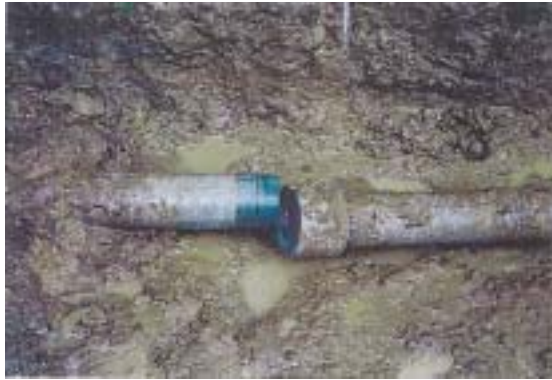
写真-3 150 ACP の継手の抜け
