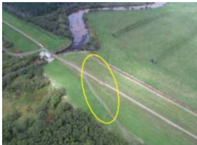
写真 - 4 十勝川左岸ウツナイ築堤（提供：北海道開発局） 旧河道にそって亀裂が発生した様子が見える
