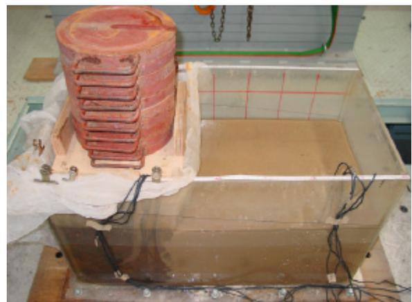
写真-2 上載圧を作用させた実験
