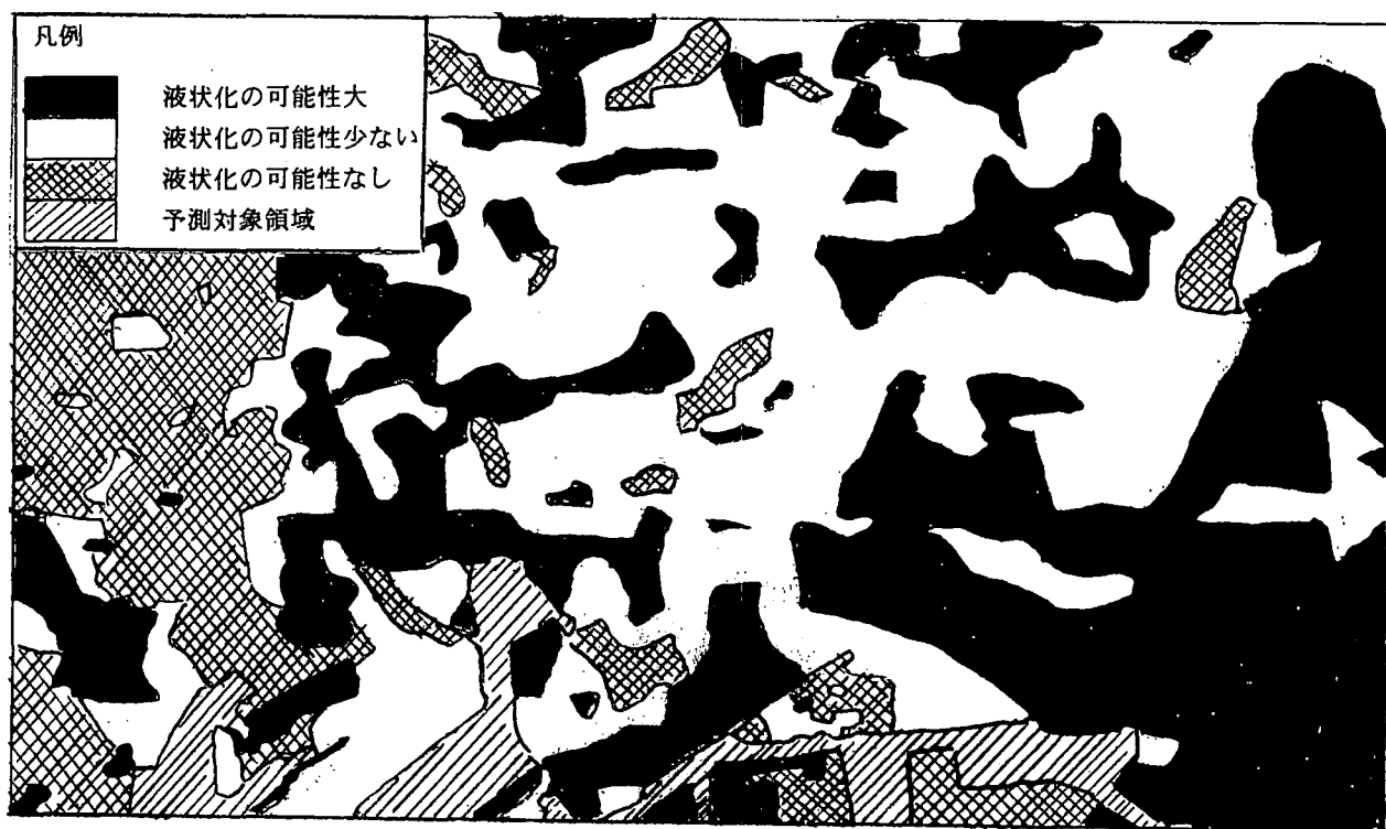
図-2 東京区部直下地震における首部の液状化予測結果
