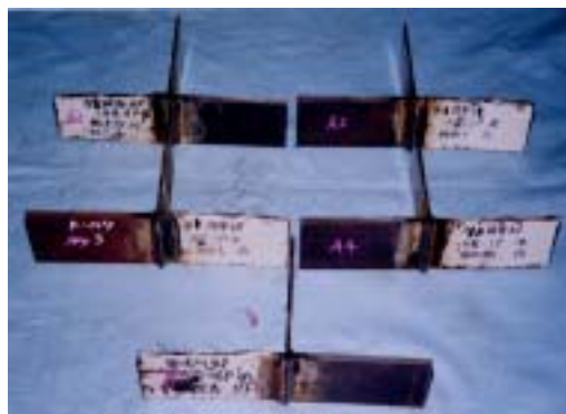
写真-1 実橋より採取した試験片の加工状況と試験方法
