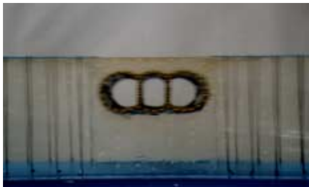
図 - 1 トンネル模型の基本振動時のブレ写真
